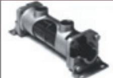
Tubos unidos con láminas de aluminio. De este modo hay una superficie de intercambio de calor 4 veces superior en comparación con un intercambiador de tubos lisos. Disipación de calor hasta 230 kW. Presión máxima: 35 a 45 bar. Desmontable para facilitar la limpieza de los tubos. Opcional con una válvula de By-pass integrada (patentado). Disponible para agua de mar.
