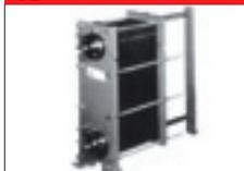
Intercambiadores a placas atornilladas de acero inoxidable para grandes aplicaciones. Debido al sistema de construcción en caja, se pueden colocar de maneras extremadamente móviles y limpiarlos fácilmente. Es posible ampliar la capacidad de disipación de energía aumentando la cantidad de placas. Varios tipos de placas y materiales. Presión de aceite hasta 25 bar y caudal de aceite de 25 a 3000 l/min. Temperaturas de servicio de -40 a +170°C.
