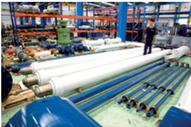
Cilindro elevación columna / electrodo. Horno de Arco
