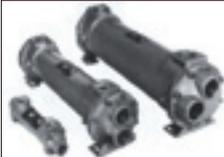
Intercambiador de tubos lisos con segmentos desviados integrados. Parecido a la serie CM, pero a base de la norma ITT (norma americana). Además 100% intercambiable con la serie BCF. Opcional: Disponible para agua de mar.
