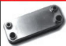
Intercambiadores de placas soldadas de acero inoxidable. Compactos y buen nivel de precio. Presión de aceite hasta 30 bar y caudal de aceite de 25 a 3000 l/min. Temperaturas de servicio desde -100 hasta +195°C. fabricados también con soldadura de níquel. Varios dispositivos de anexo e aislamientos de espuma dura PU.
