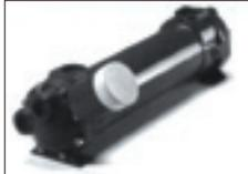
Intercambiador de tubos lisos con segmentos desviados integrados a base de la serie AM. A causa de los tubos dobles no se mezclan los dos medios, de este modo está protegido contra la sobrepresión así como contra la corrosión. Un acumulador en la parte delantera equilibra los cambios térmicos de uno de los medios entre los tubos dobles y mantiene la presión de este medio al mismo nivel. En caso de que exista comunicación en uno de los tubos, este será indicado por los detectores de presión.
